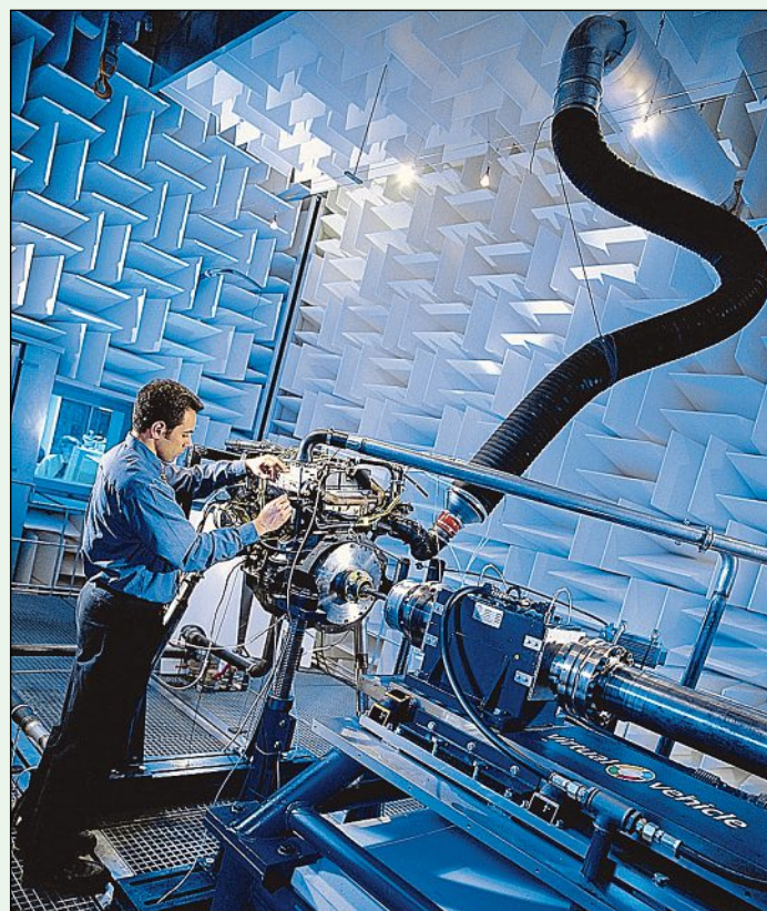
Ein Prüfstand um Reibungsverluste von Motoren aufzuzeichnen
