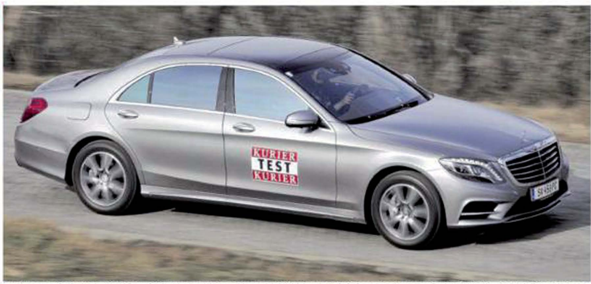
Dank Plug-in-Hybrid fährt der S500 bis zu 140 km/h rein elektrisch. Die elektrische Reichweite ist jedoch noch ausbaufähig. Die chinesische Vorgabe von 50 km ist weit weg
