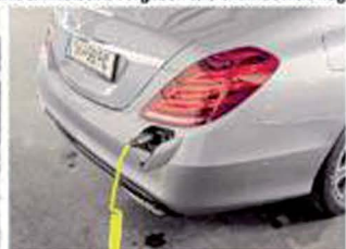
Dank Plug-in-Hybrid fährt der S500 bis zu 140 km/h rein elektrisch. Die elektrische Reichweite ist jedoch noch ausbaufähig. Die chinesische Vorgabe von 50 km ist weit weg
